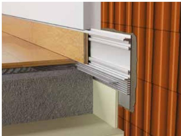
BFZ es un perfil de construcción que le permite hacer un rodapié a ras de la pared con el mismo material que el pavimento. En la parte inferior hay ranuras especiales, diseñadas para permitir el encastre de un perfil lineal, diseñado para determinar el plano de la solera y garantizar un posicionamiento perfecto de las alturas de puertas y ventanas.
